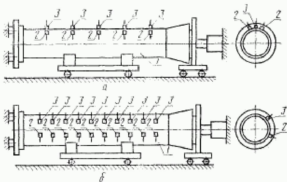
1 — труба; 2 — излучатель; 3 — приемники
