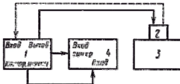
1 - электронный блок дефектоскопа; 2 - преобразователь; 3 - стандартный образец; 4 - осциллограф
