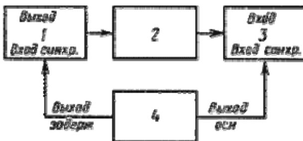
1 - электронный блок дефектоскопа; 2 - номинальный эквивалент нагрузки генератора импульсов возбуждения; 3 - осциллограф; 4 - генератор прямоугольных импульсов
