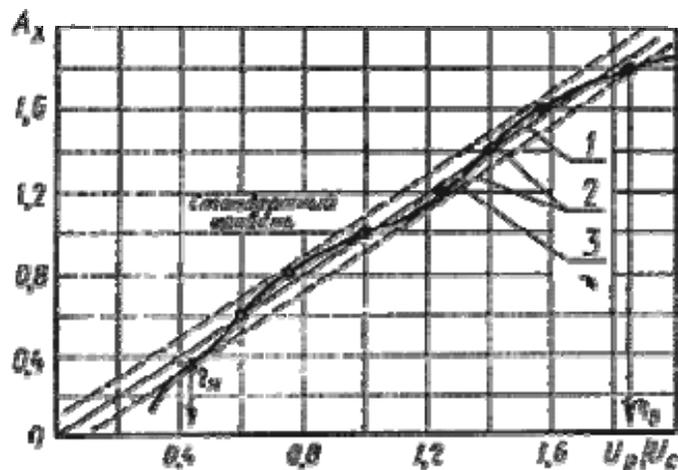
1 - линия идеальной линейности, проведенная через начало координат и точку, полученную на стандартном уровне; 2 - верхняя и нижняя границы нелинейности, проведенные параллельно линии 1; 3 - амплитудная характеристика приемного тракта;  $N_{min}, N_{max}$  - верхняя и нижняя границы динамического диапазона в дБ
